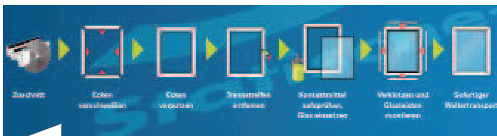
Fertigungsablauf mit STV-Integration
